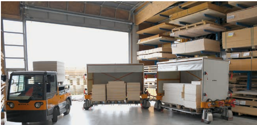
▲ Spurtreu und sicher: Ein Routenzug garantiert den beschädigungsfreien Transport der zugeschnittenen Teile (Bild: HOB)
